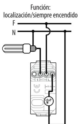
Compatibles con lámparas LED y lámparas ahorradoras. Recomendado para obtener la compatibilidad del foco piloto con cualquier tipo de lámpara.
