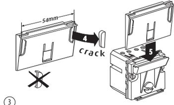
③ Romper las prerrupturas de la sotoplaca y reensamblarla con el interruptor.
