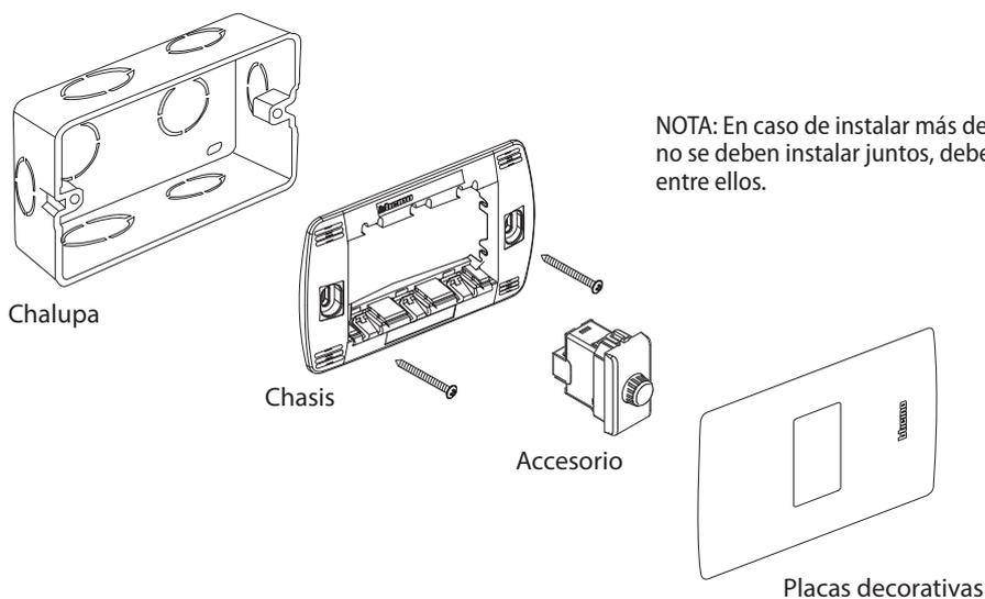
NOTA: En caso de instalar más de un dimmer en la placa, no se deben instalar juntos, debe haber un módulo libre entre ellos.
