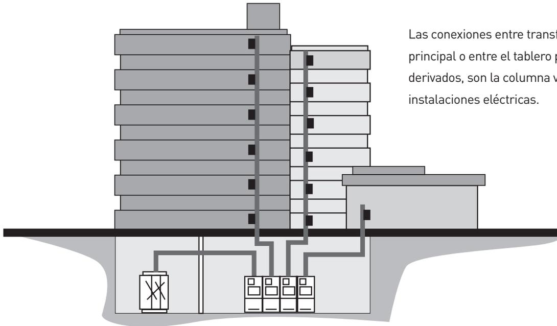
Las conexiones entre transformador y tablero principal o entre el tablero principal y tableros derivados, son la columna vertebral de las instalaciones eléctricas.
