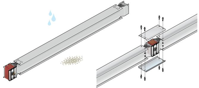
Gracias a la estructura ferromagnética y su diseño compacto el electroducto Zucchini presenta un nivel de emisiones electromagnéticas mucho menor ( $< 3$  MicroTeslas medido a 1 metro del electroducto) comparado con un sistema convencional de cables para la misma capacidad de corriente. Por lo que ofrece mayor seguridad en instalaciones con presencia de personas y/o equipos sensibles a las emisiones electromagnéticas.
