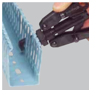
Corte de refuerzo lateral entre lengüetas con pinza 367 10.
