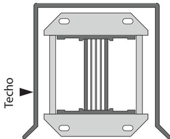
Gracias a la estructura ferromagnética y su diseño compacto el electroducto Zucchini presenta un nivel de emisiones electromagnéticas mucho menor ( $< 3$  MicroTeslas medido a 1 metro del electroducto) comparado con un sistema convencional de cables para la misma capacidad de corriente. Por lo que ofrece mayor seguridad en instalaciones con presencia de personas y/o equipos sensibles a las emisiones electromagnéticas.
