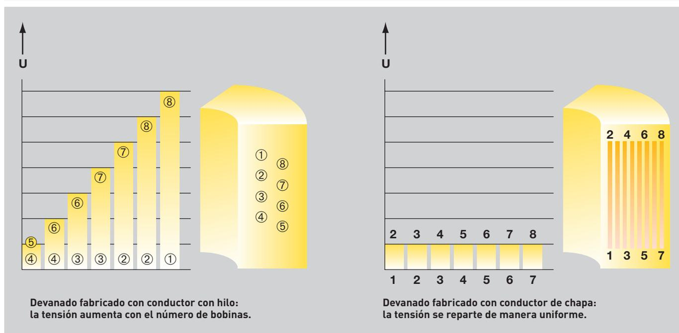
Los transformadores con devanados de chapa presentan en consecuencia una mayor capacidad de resistencia a las tensiones de impulso y a la frecuencia industrial, así como una menor probabilidad de ser lugar de descargas parciales.
