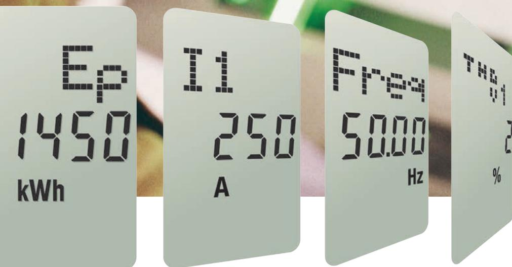
Corriente, tensión, frecuencia, potencia, energía, THD.
