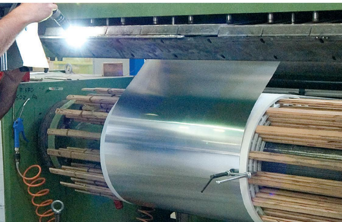
Soldadura TIG en atmósfera controlada para las conexiones de BT.
