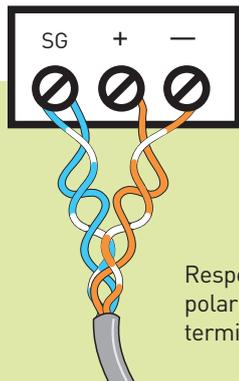
Respetar la correcta polaridad de conexión en las terminales del dispositivo.
