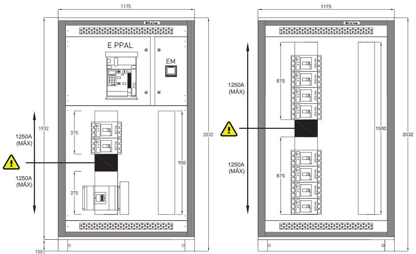
El Tablero está diseñado para sistemas 3F-4H el cual incluye barra de neutro al 100% montado sobre el Bus Horizontal, la barra de tierra se suministra a todo lo ancho del tablero en la parte inferior.
