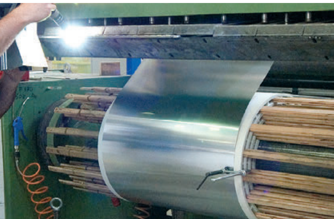
Soldadura TIG en atmósfera controlada para las conexiones de BT.
