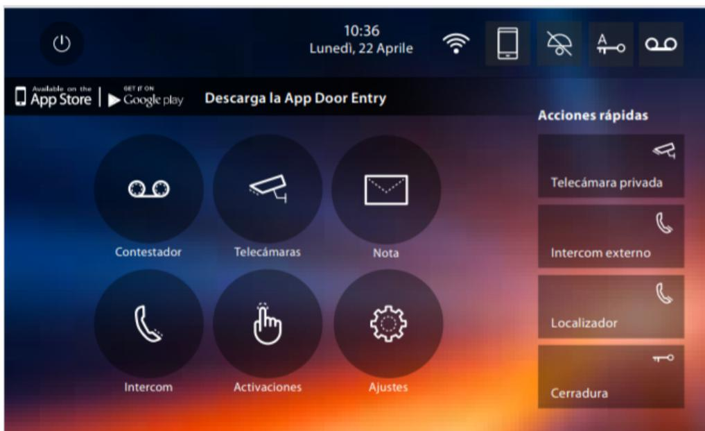
**Paso 2:** En la sección de Ajustes, selecciona la pestaña de Configuración y luego en Reset del Dispositivo.
